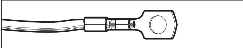
Подключите силовой кабель от распределительного шкафа и кабель управления от пульта (других завес) к распределительной коробке, при этом клемму с проводом заземления наденьте на болт между оставшимися шайбами, наверните и затяните ключом вторую гайку.
