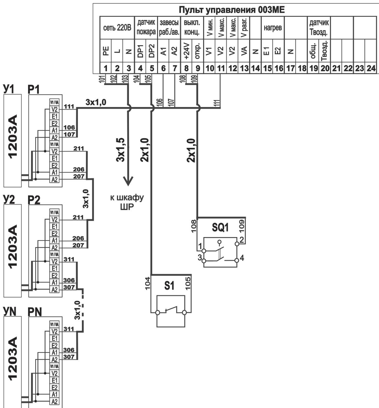
**S1** - датчик пожара; **SQ1** - выключатель концевой;
