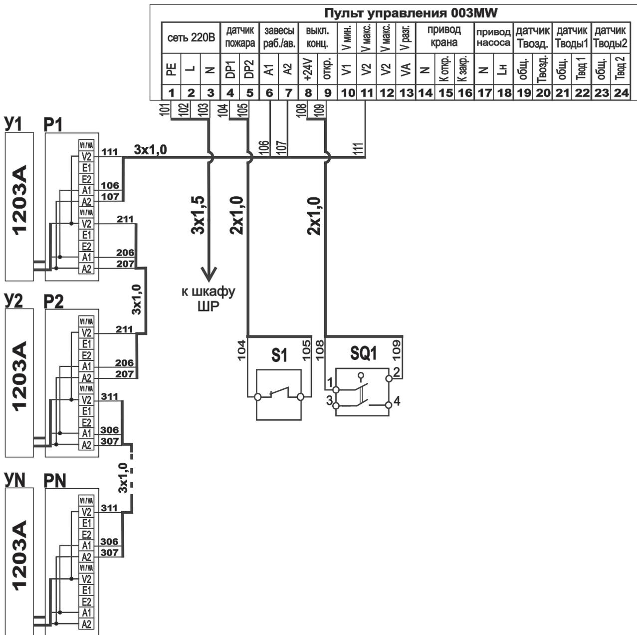
S1 - датчик пожара; SQ1 - выключатель концевой;
