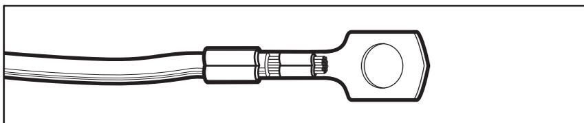
Подключите силовой кабель от распределительного шкафа и кабель управления от пульта (других завес) к распределительной коробке, при этом клемму с проводом заземления наденьте на болт между оставшимися шайбами, наверните и затяните ключом вторую гайку.
