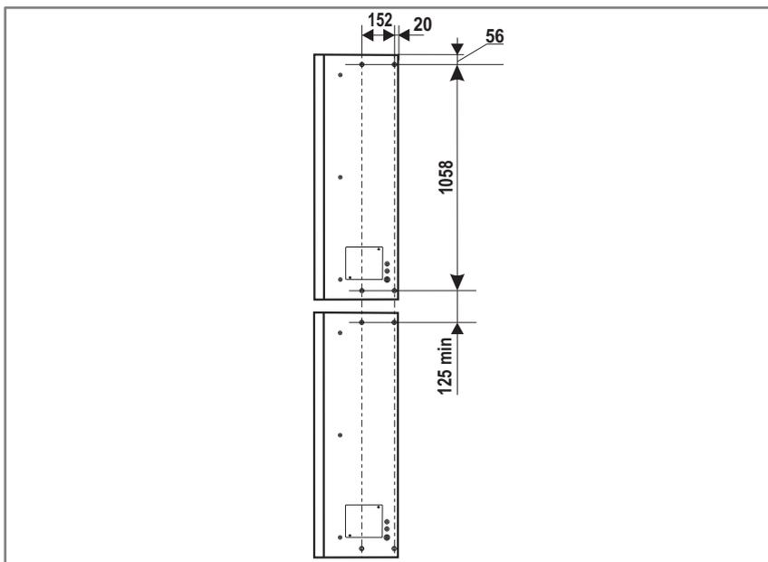
На свободном месте на стене рядом с завесой (на расстоянии не более **1,3 м** от места ввода кабелей в завесу) произведите разметку отверстий под установку распределительных коробок из комплекта поставки в соответствии с **Рисунком 6**. Просверлите отверстия.
