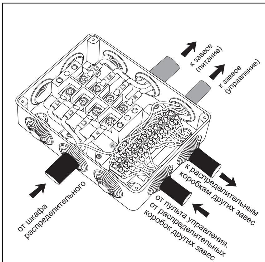
Подключите силовой кабель и кабель управления из завесы в соответствии с маркировкой жил к соответствующим клеммам зажимов. Для подключения провода заземления предварительно свинтите гайки болта заземления, снимите шайбы, наденьте клемму заземления на болт между основанием и шайбой, наверните и затяните ключом **10мм** одну гайку.
