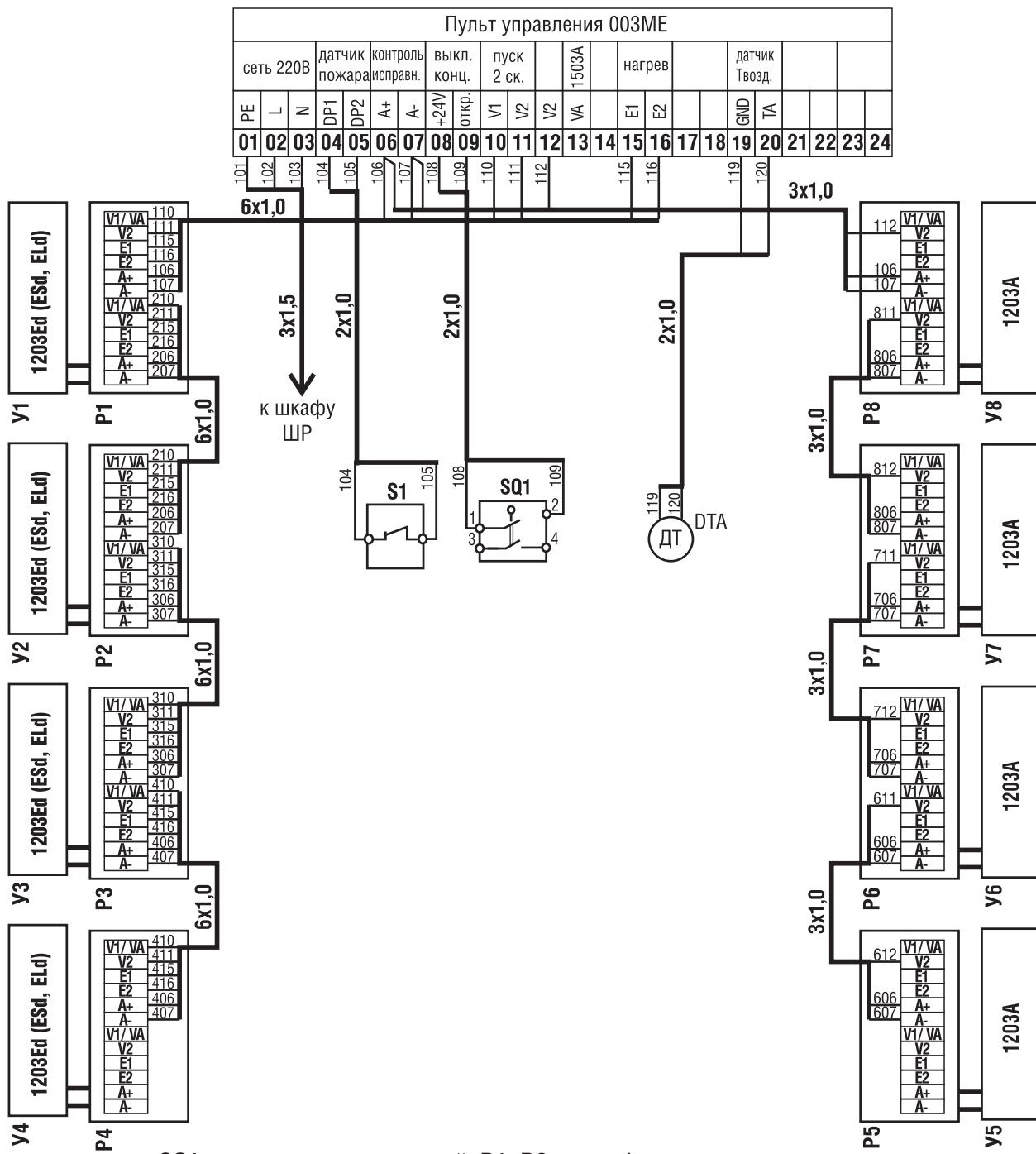
**S1** - датчик пожара; **SQ1** - выключатель концевой; **P1...P8** - коробка распределительная;
