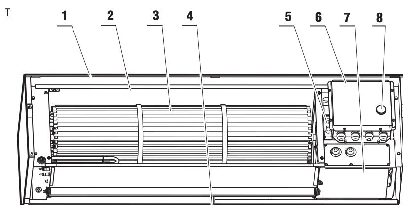
**1.4.3** Для защиты электродвигателя завес от токовых перегрузок недопустимой продолжительности, в том числе возникающих при выпадении одной из фаз, в цепи его электропитания установлено электротепловое токовое реле. При аварийном срабатывании реле загорается индикатор **8**. Восстановление электропитания двигателя осуществляется автоматически после отпускания теплового реле.
