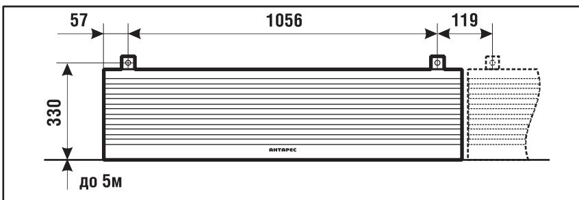
Крепление завесы к горизонтальному кронштейну осуществляется с помощью штатных кронштейнов крепления, входящих в комплект поставки.
