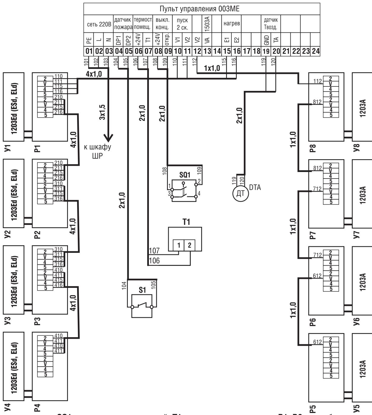
**S1** - датчик пожара; **SQ1** - выключатель концевой; **T1** - термостат помещения; **P1...P8** - коробка распределительная;
