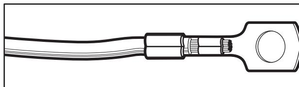
Подключите силовой кабель, провод заземления от распределительного шкафа и кабель управления от пульта (других завес) к распределительной коробке в соответствии с разделом **2.2.5**, при этом клемму с проводом заземления наденьте на болт между оставшимися шайбами, наверните и затяните ключом вторую гайку.
