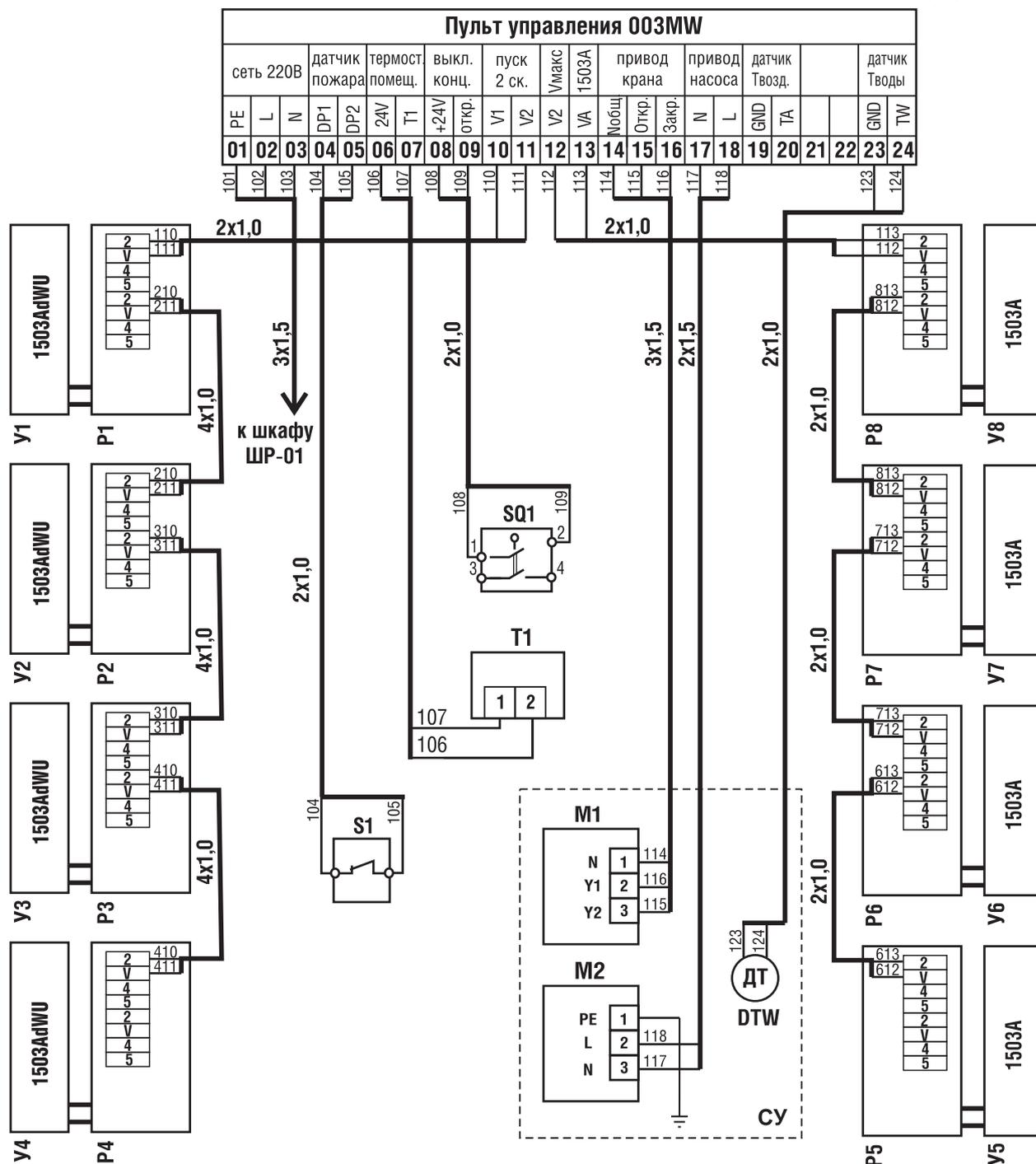
**S1** - датчик пожара; **SQ1** - выключатель концевой; **T1** - термостат помещения; **CY** - смесительный узел "Антарес" серии А-УС; **P1...P8** - коробка распределительная;
