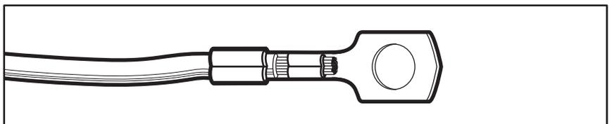
Подключите силовой кабель, провод заземления от распределительного шкафа и кабель управления от пульта (других завес) к распределительной коробке, при этом клемму с проводом заземления наденьте на болт между оставшимися шайбами, наверните и затяните ключом вторую гайку.
