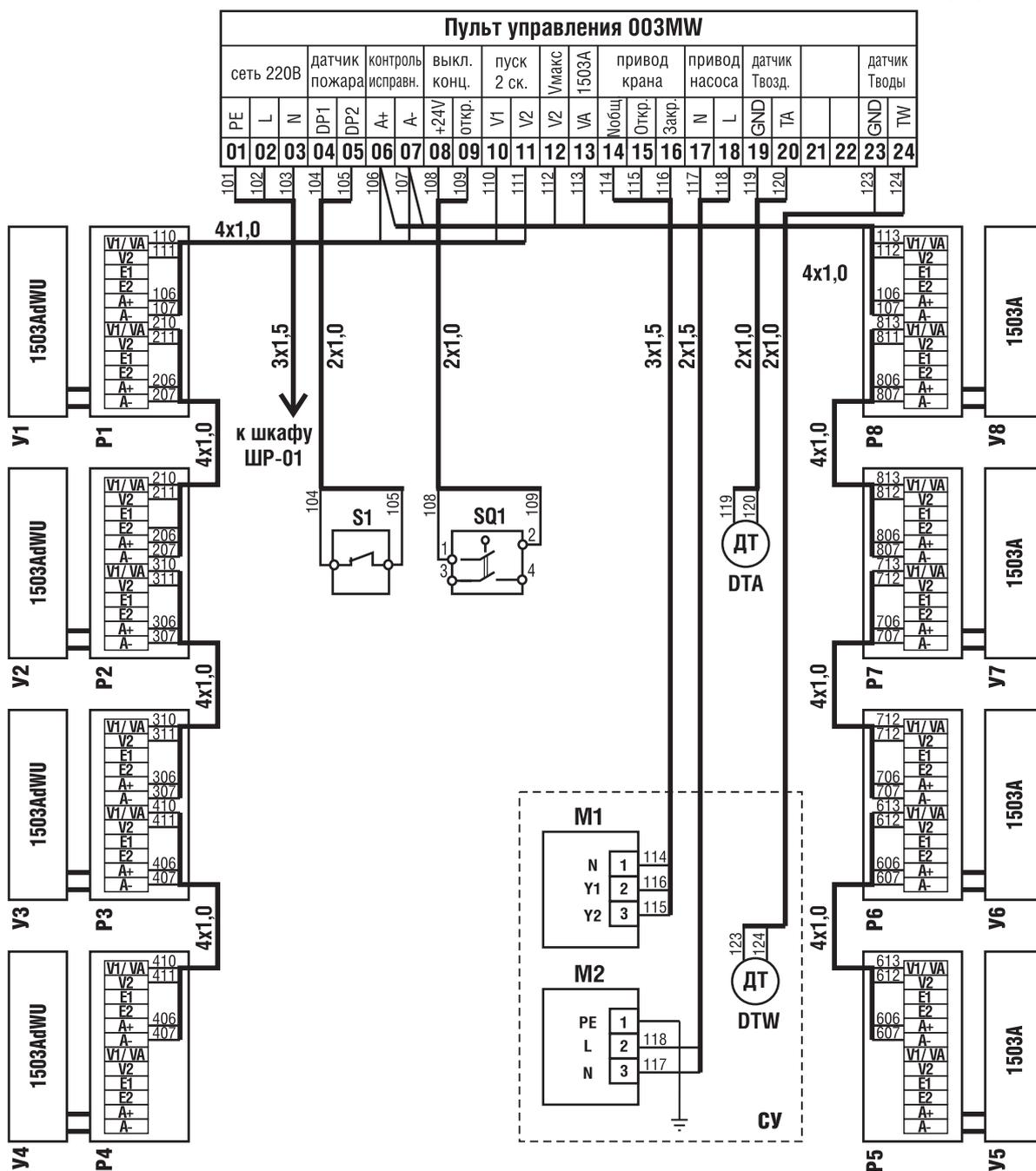
**S1** - датчик пожара; **SQ1** - выключатель концевой; **СУ** - смесительный узел "Антарес": серии **A-УС**;
