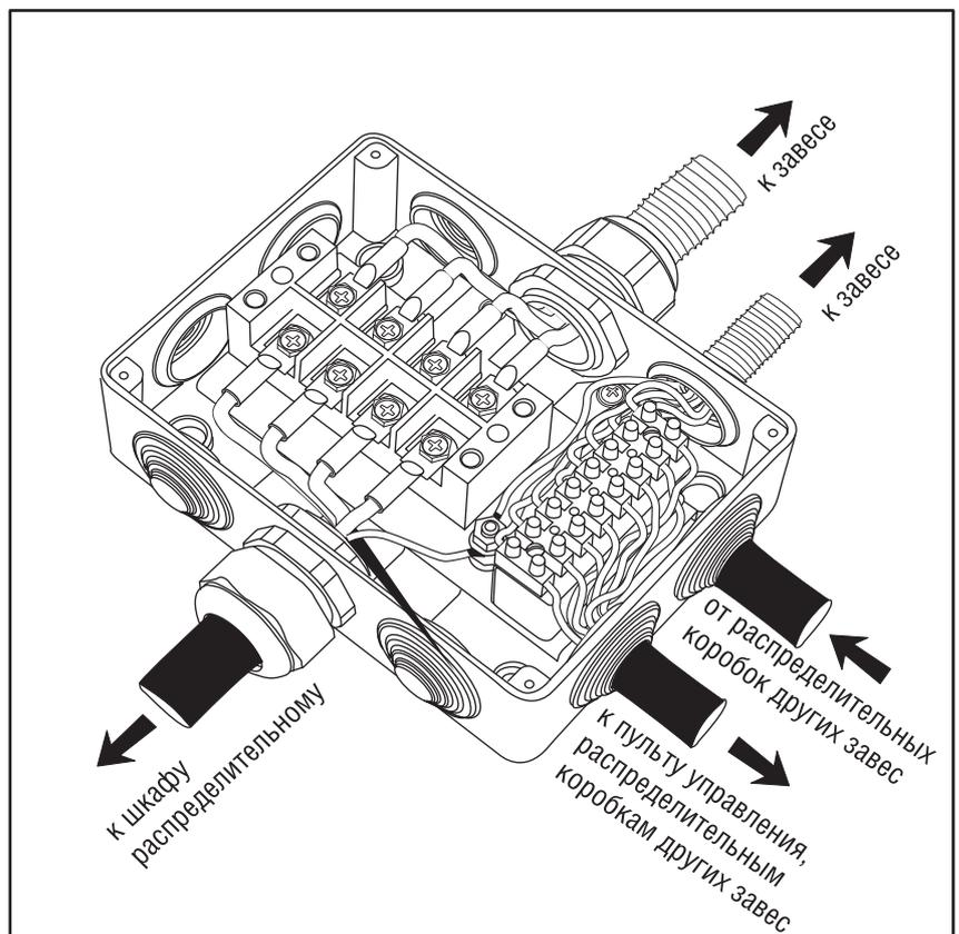
Обрезав провод заземления от распределительного шкафа и зачистив изоляцию на длине примерно **5мм**, обожмите плоскогубцами клемму заземления из комплекта поставки завесы, как это показано на **рисунке 14**.
