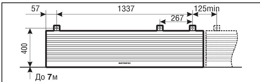
Крепление завесы к горизонтальному кронштейну осуществляется с помощью штатных кронштейнов крепления, входящих в комплект поставки.
