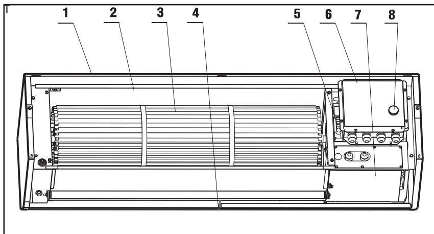
**1.4.3** Для защиты электродвигателя завес от токовых перегрузок недопустимой продолжительности, в том числе возникающих при выпадении одной из фаз, в цепи его электропитания установлено электротепловое токовое реле. При аварийном срабатывании реле загорается индикатор **8**. Восстановление электропитания двигателя осуществляется автоматически после отпускания теплового реле.
