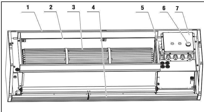
**1.4.4** Принцип действия завесы заключается в формировании плоского потока воздуха, направленного вдоль плоскости входного проема и предотвращающего проникновение наружного воздуха в помещение. Забор воздуха осуществляется через входную решетку **1** (здесь и далее **рисунок 2**). Металлический фильтр в виде сетки **2**, установленный во входной решетке, исключает попадание частиц крупноволокнистой пыли на рабочее колесо.
