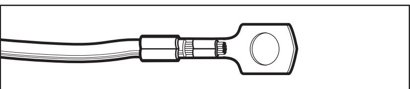
Подключите силовой кабель, провод заземления от распределительного шкафа и кабель управления от пульта (других завес) к распределительной коробке в соответствии с разделом **2.2.8**, при этом клемму с проводом заземления наденьте на болт между оставшимися шайбами, наверните и затяните ключом вторую гайку.
