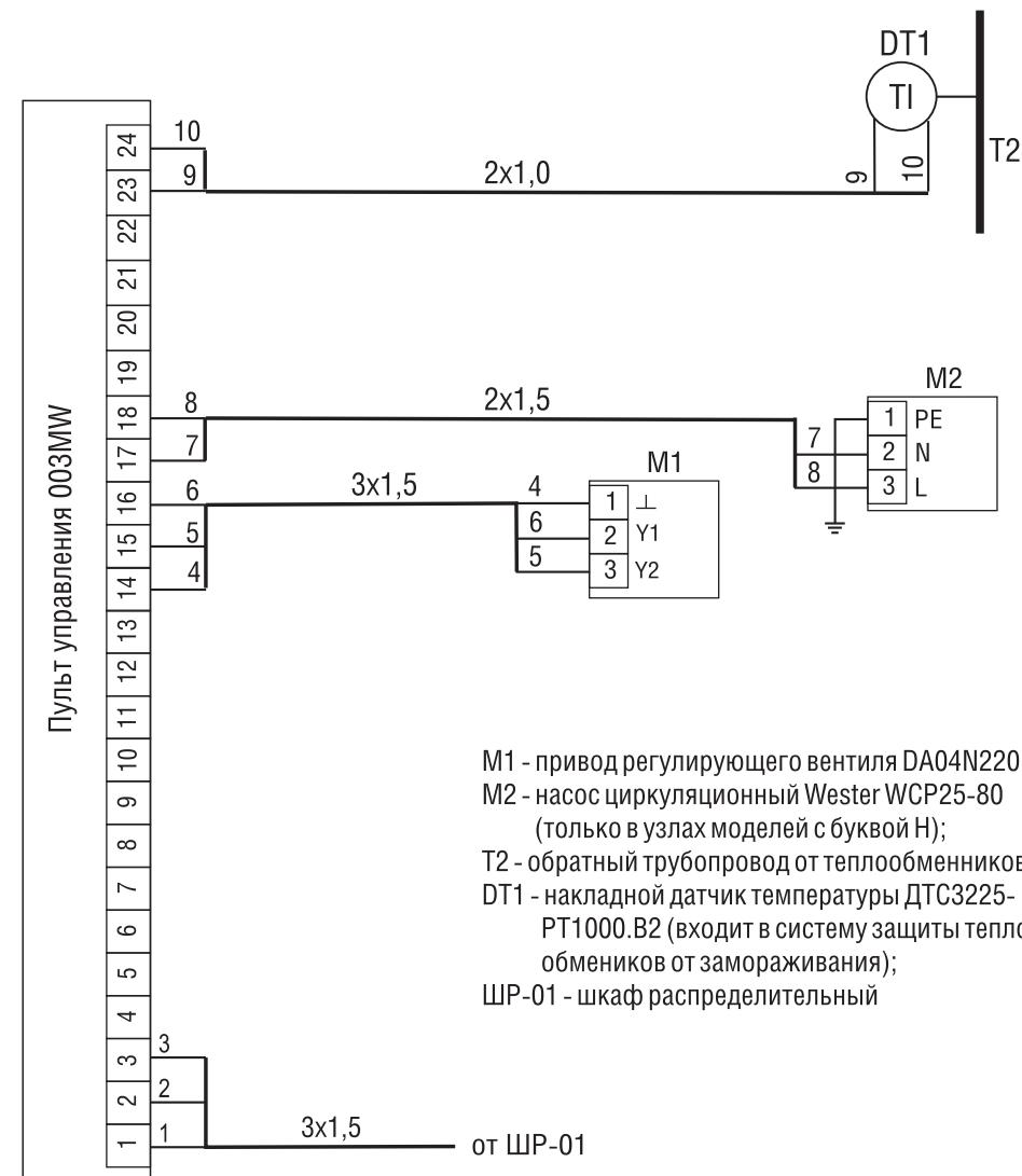
M1 - привод регулирующего вентиля DA04N220;
