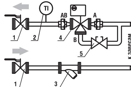
**Рисунок 2 - Схема смесительного узла при  $P < 40$  кПа**
